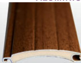
En 43 mm de largeur, elles sont isolées double paroi offrant confort et tranquillité. La densité de mousse isolante intérieure est de 90 kg/m<sup>3</sup>. Ceci améliore la tenue et la rigidité des lames.
